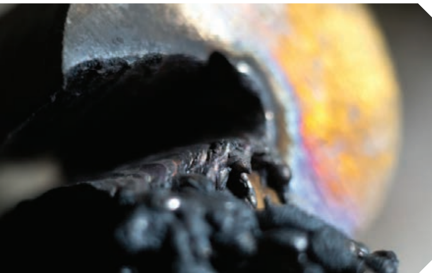
Формирующий телескоп МЛТК-20 (слева); лазерная дистанционная резка толстостенных металлоконструкций (вверху)
