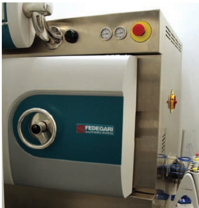
Автоклав для стерилизации оборудования (слева); циклотрон для получения медицинских радиофармпрепаратов (справа)
